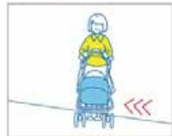
左右のタイヤがモーターにより同速度で回転し、傾斜のある道で車体が下り側に流れてしまうことを防止。
