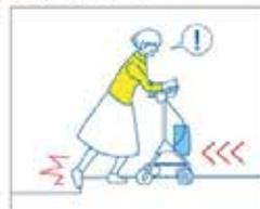
急な動きが発生し、バランスが崩れそうになった際にセンサーで感知しブレーキ制御で転倒を防止。
